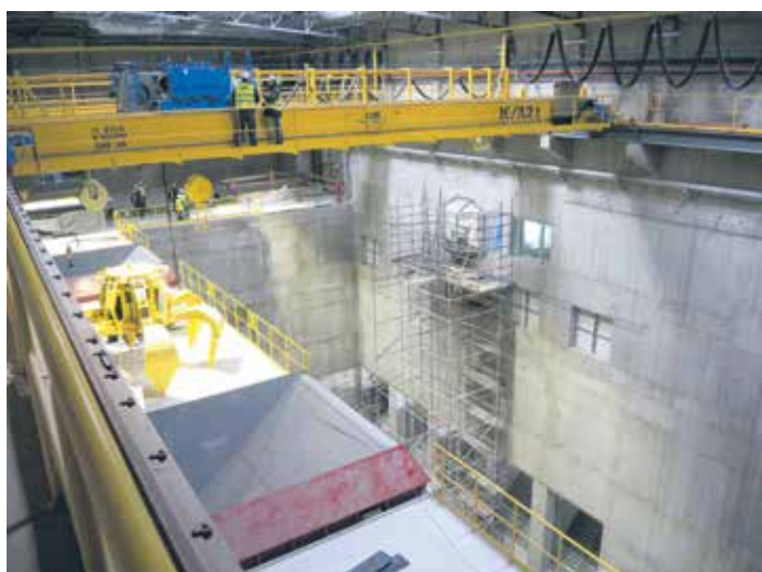
19 października przedstawiciel Urzędu Dozoru Technicznego sprawdzał prawidłowość działania suwnic EcoGeneratora. Na zdjęciu z lewej; próbny przejazd dźwigarem, z prawej Antoni Mieczkowski z firmy GH Cranes w fotelu operatora suwnicy.
